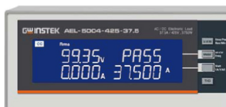
Turbo OFF, Short 100ms 37.5A 测试结果画面
